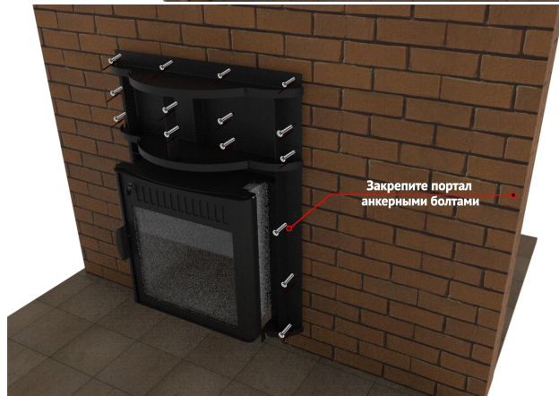
Рисунок 8.2. Схема установки печи
